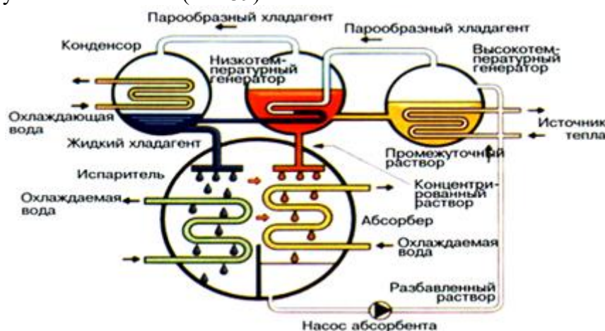
Рис. 39. Схема двухступенчатой абсорбционной холодильной машины.
