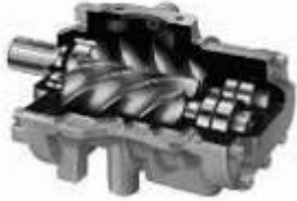
Рис. 20 Устройство двухвинтового компрессора Ротационные компрессоры
