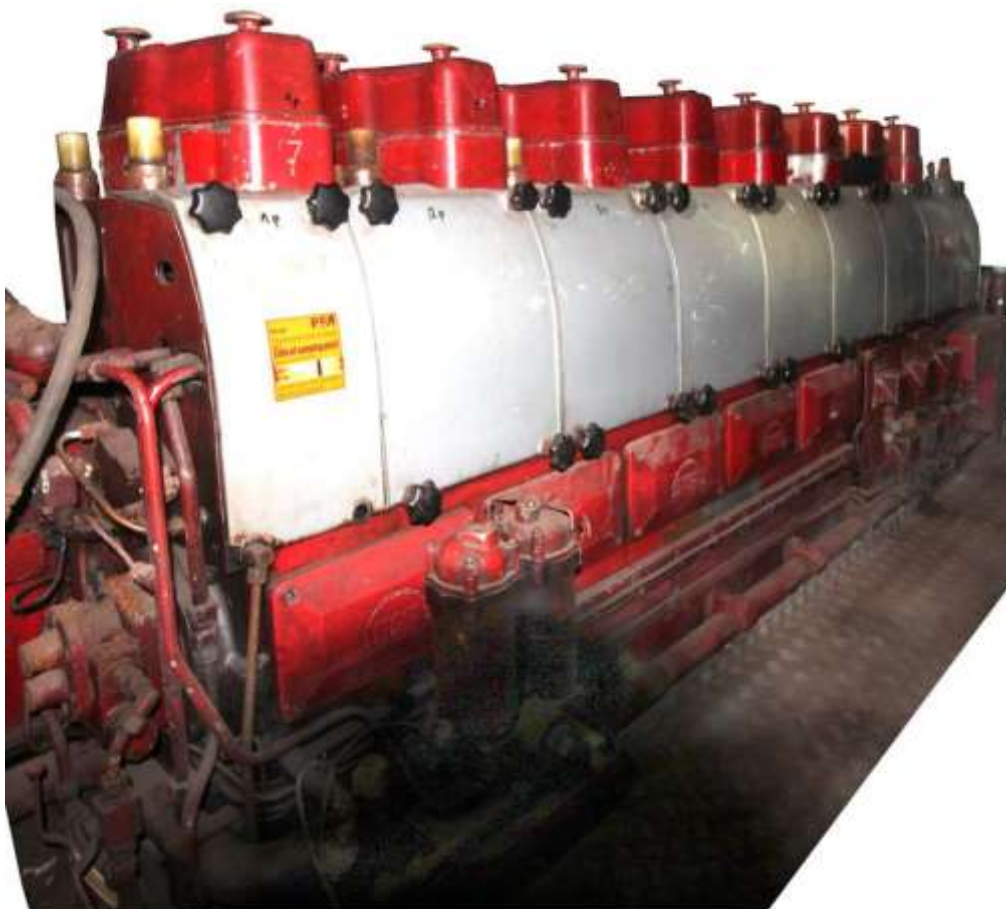
MAN B&W Alpha 8L23/30A DKV 1280 kW @ 900 RPM
