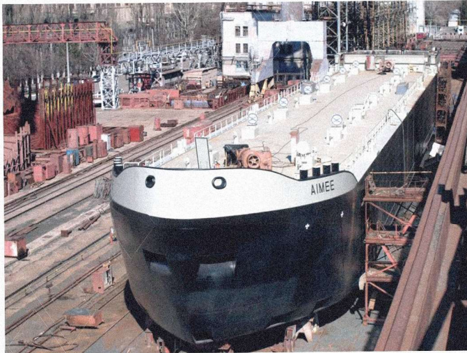
Рисунок 2 – Стапель ТОВ “Смарт-Мері тайм Груп” Херсонська верф, корпус танкера, в побудові якого приймали участь здобувачі освіти 4-го курсу спеціальності 135 “Суднобудування” під час проходження технологічної практики.
