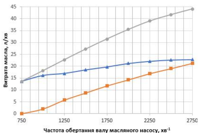
Рис. 4. Залежність продуктивності масляного насоса ● та витрати моторного масла в напірну масляну магістраль ▲ і лінію зливу ■ при встановленому масляному фільтрі ФМ 009-1012005
