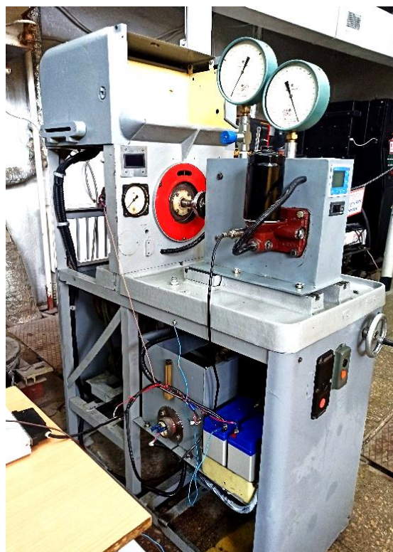
Рис. 1. Загальний вигляд стенду для дослідження експлуатаційних параметрів елементів системи мащення ВОД
