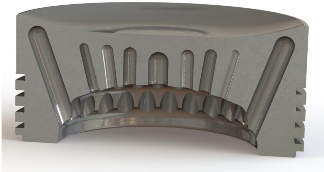
Рисунок 1 – Твердотільна модель головки поршня двигуна Wartsila RT-flex96C
