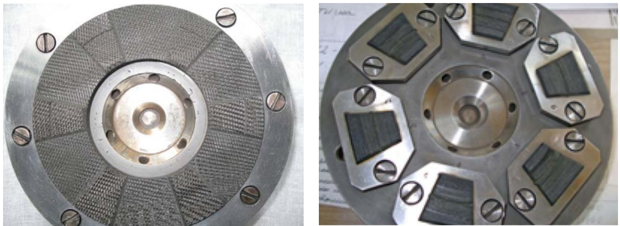
Рис. 1.8. Упорний підшипник відцентрового насосу із вуглепластика «ФУТ» [75].
