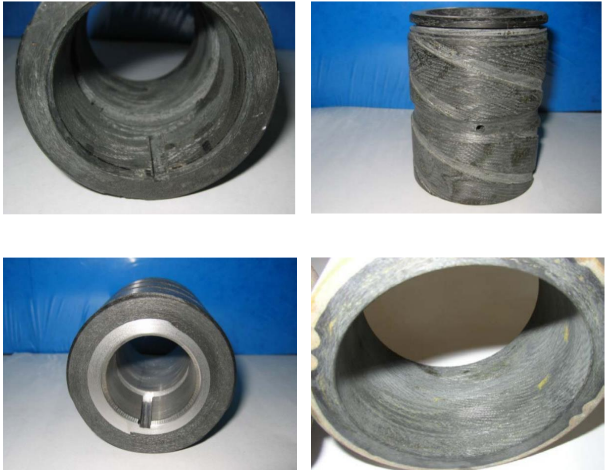
Рис. 1.9. Підшипники конденсатних електронасосів різної продуктивності із фенольного вуглепластика «ФУТ» [75].
