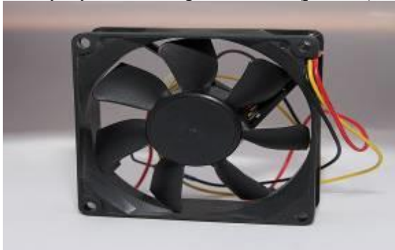
Рис. 17. Осевой вентилятор для охлаждения компьютера
