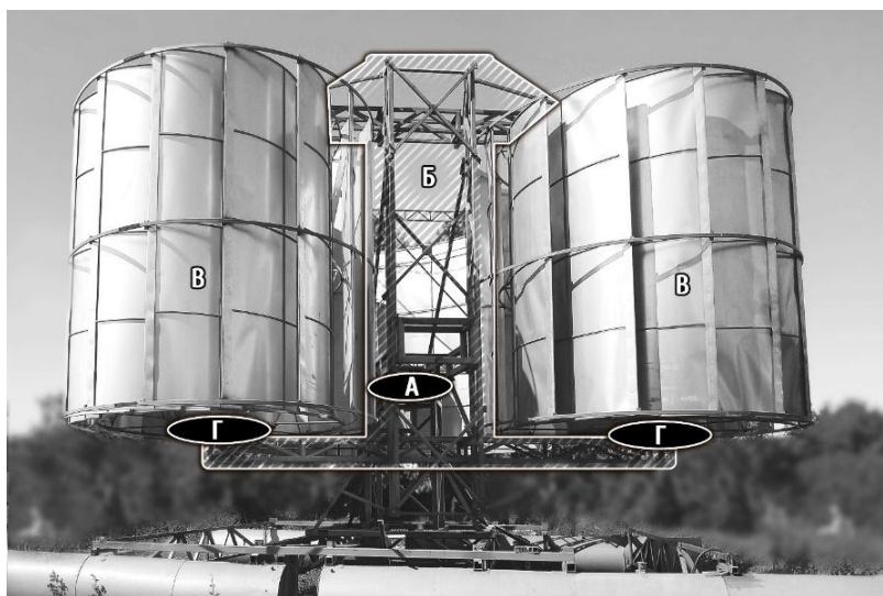
Рисунок 2 – Пристрій активного вітрила: поворотна опора (поворотний підшипник великого діаметра) (а), на якій встановлено каркас обтічника (б) і дві вертикальні турбіни (в) карусельного типу, електричні генератори з мультиплікаторами (г)
