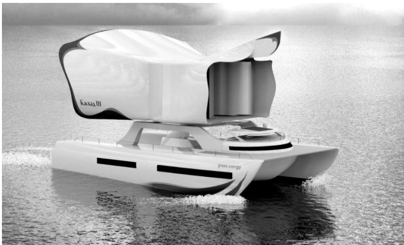
Рисунок 1 – Загальний вигляд яхти-катамарана, що має електродвигуни як у звичайного судна, але основним рушієм якої є активна енергетична вітрильна установка нового типу
