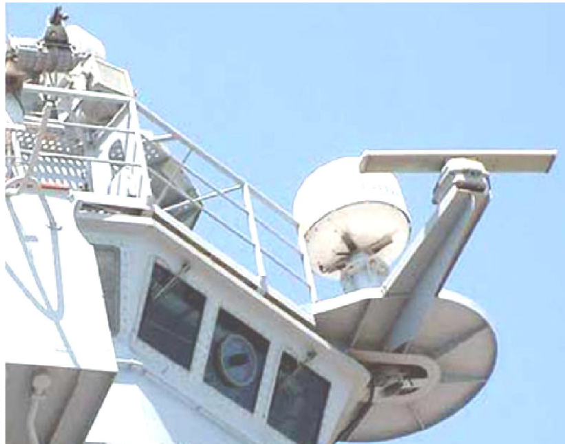
Рисунок 4 – Слева – РЛС «Кивач», справа: корпус (механическая часть и датчик угла положения антенны) как у РЛС «Кивач», а излучатель антенны как у РЛС «Печора-1»
