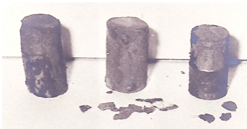
Рисунок 2 – Контрольные образцы после нагрева в атмосфере печи, слой окалины до 2 мм
