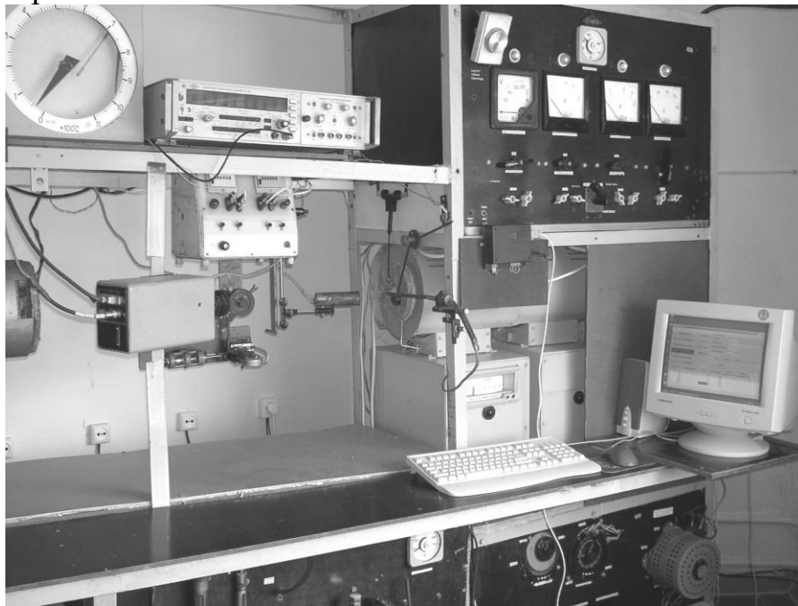
Рис. 1. Общий вид экспериментальной установки по определению воспламеняемости неподвижной (подвешенной) капли жидкого топлива в потоке воздуха
