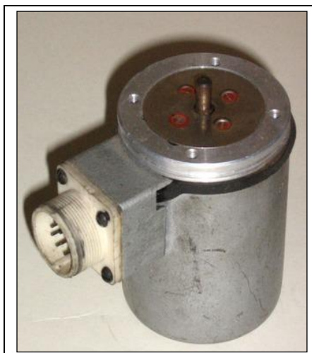
Рисунок 2. Датчик фотоелектричний перетворювач кутових переміщень VE178A.
