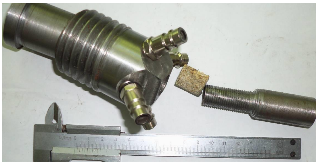
Рисунок 7. Готова збірна одиниця сопла нової конструкції. а – САПР модель збірної одиниці сопла (1 – корпус; 2 - широкий конічний вхід; 3 - пориста циліндрична трубчаста вставка; 4 - вузький довгий конічний вихід); б – реально виготовлена збірна одиниця сопла.
