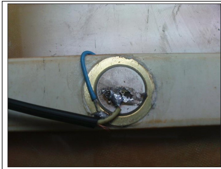
Рисунок 6. Зображення наклеювання п'єзoeлементів на балку та підключення датчика до звукової плати комп'ютера.
