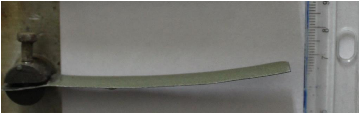
Рисунок 2 – Изгиб образца первого типа за счет действия в эпоксидном покрытии толщиной 0,7 мм остаточных напряжений
