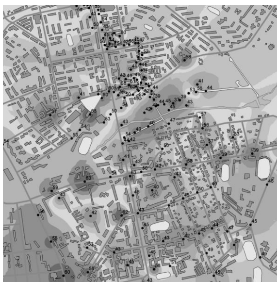
Рисунок 8 – Карты шума того же района (построено по показателю: уровень звукового давления, дБ в октавной полосе частот со среднегеометрической частотой 250 и 500 Гц соответственно)
