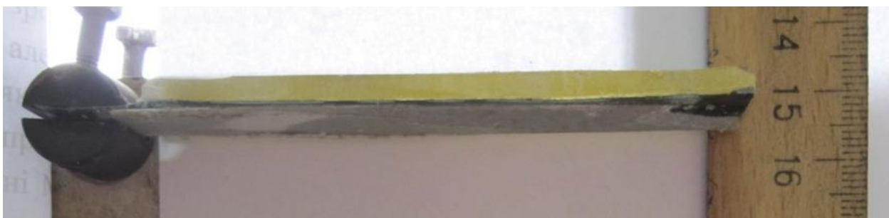
Рисунок 3 – Образец второго типа с эпоксидным покрытием толщиной 4 мм
