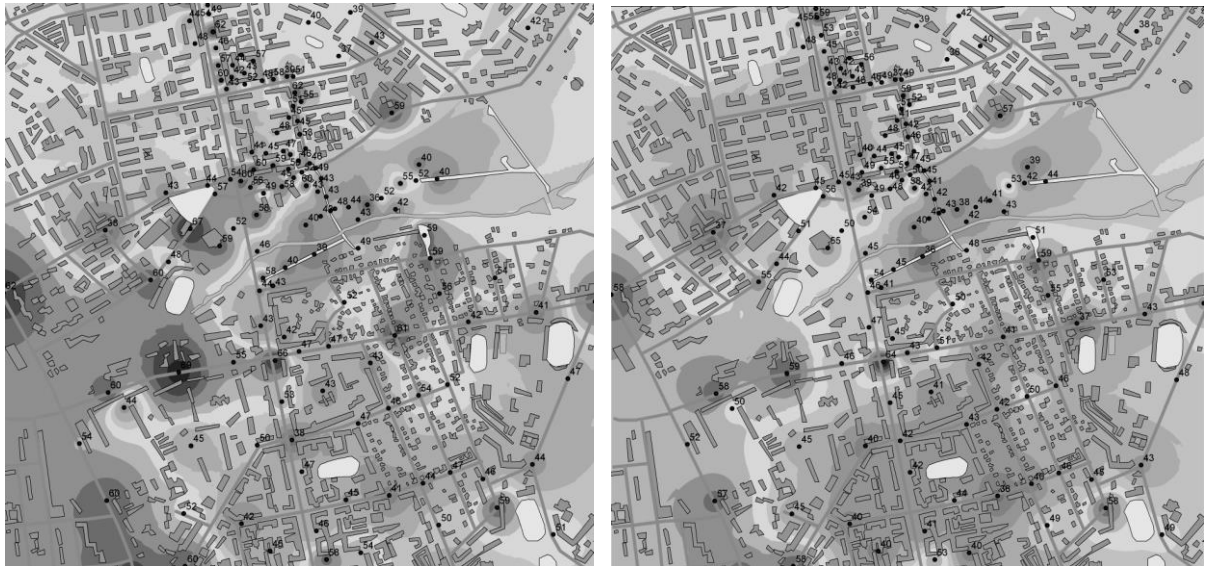
Рисунок 9 – Карты шума того же района (построено по показателю: уровень звукового давления, дБ в октавной полосе частот со среднегеометрической частотой 1000 и 2000 Гц соответственно)
