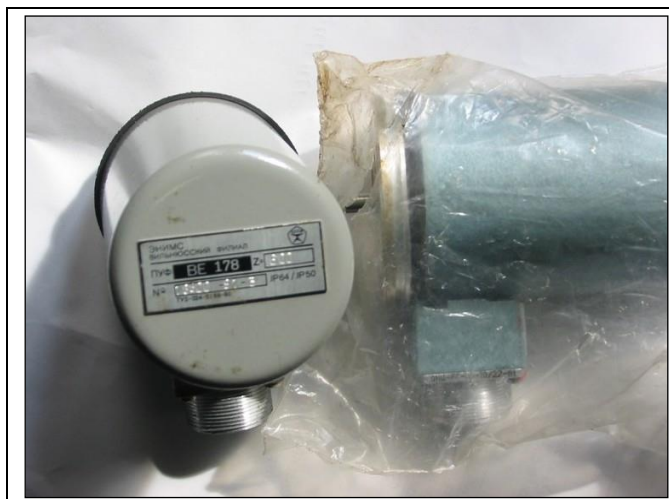
Рисунок 2. Датчик фотоелектричний перетворювач кутових переміщень VE178A.
