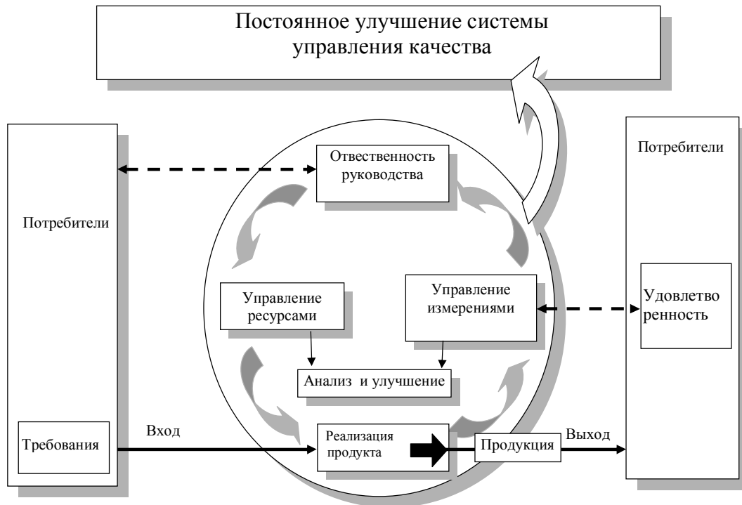
Рисунок 2 – Модель СУК, в основе которой заложены процессы
