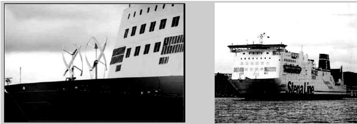
Рисунок 14 – Установка вітрових електрогенераторів на поромі Stena Jutlandica
