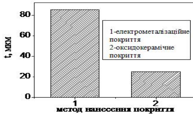
Рисунок 2 – Залежність товщини покриття від методу його нанесення
