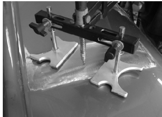
Рисунок 3 – Механические вытяжные устройства для внешнего устранения вмятин концерна «Beulentechnik AG»
