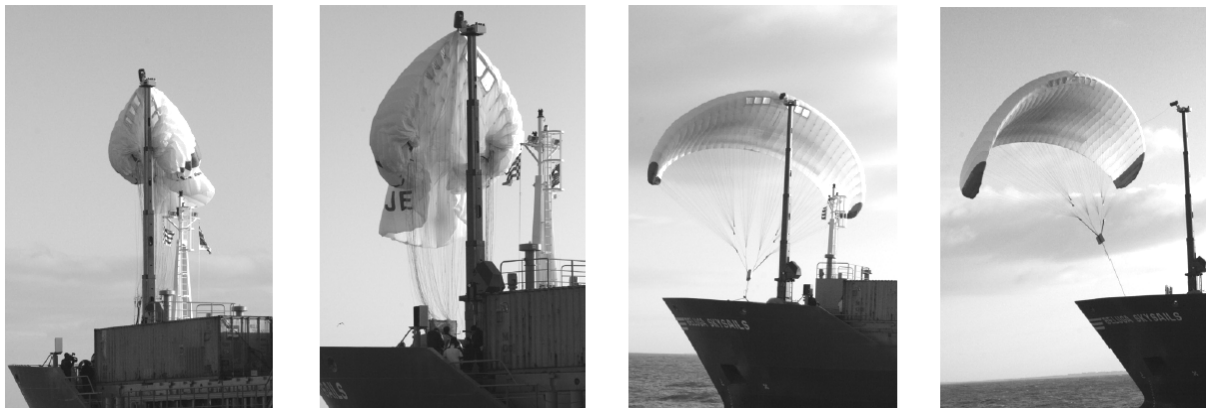
Рисунок 7 – Початковий етап підйому і запуску вітрила системи «SkySails» (при спуску вітрила етапи мають зворотній вигляд)
