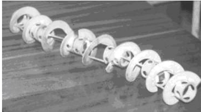
Рисунок 1 – Загальний вигляд окремих секцій гвинтового робочого органу конвеєра
