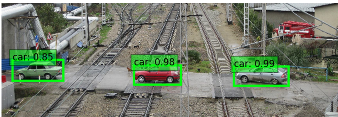
Рисунок 6 – Результат обробки зображення переїзду мережею SSD
