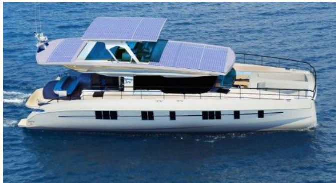
Рисунок 10 – Яхта «Solarwave 62» фирмы «Solarwave» на солнечных батареях, построенная в 2014 г. судостроительной компанией «Nedship» (Швейцария – Турция)
