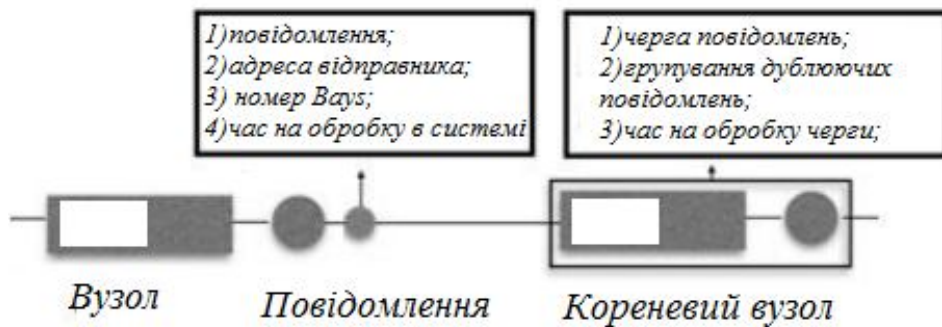
Рисунок 6 – Елементи моделі бездротової мережі контейнеровозу
