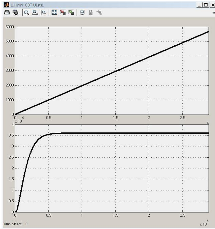
Рисунок 6 – Программа изменения расхода F(t) (ХНТУ) и изменение потенциала \varphi(t) поверхности СПЖ во время реализации этой программы
