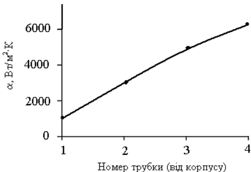
Рисунок 4 – Вплив положення трубки на величину коефіцієнта тепловіддачі
