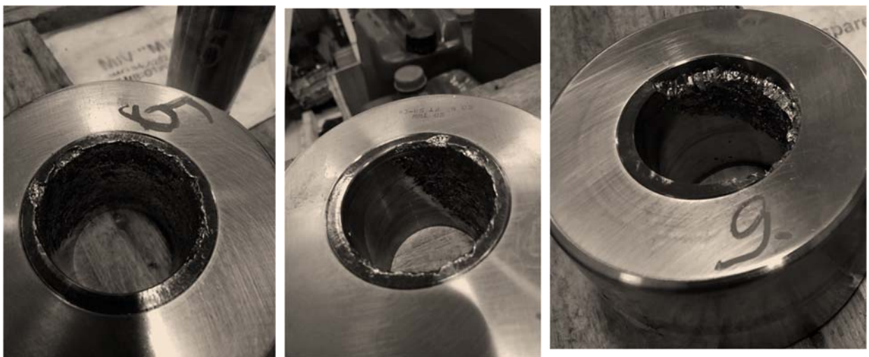
Рисунок 1 – Фотографії роликів приводу ПНВТ зі зруйнованими підшипниковими втулками
