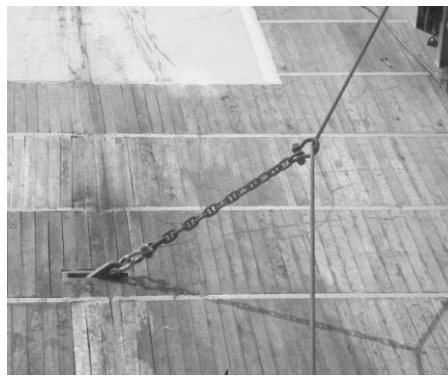
Рисунок 10 – Стационарний гоб (гоб) – пристрій для запобігання ризику буксирного троса (а), та Гоб (гоб) ланцюг – пристрій для запобігання ризику буксирного троса (б). Фото автора
