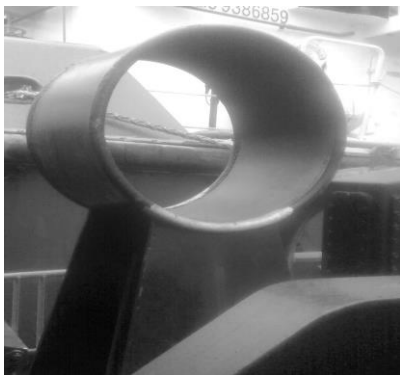
Рисунок 10 – Стационарний гоб (гоб) – пристрій для запобігання ризику буксирного троса (а), та Гоб (гоб) ланцюг – пристрій для запобігання ризику буксирного троса (б). Фото автора
