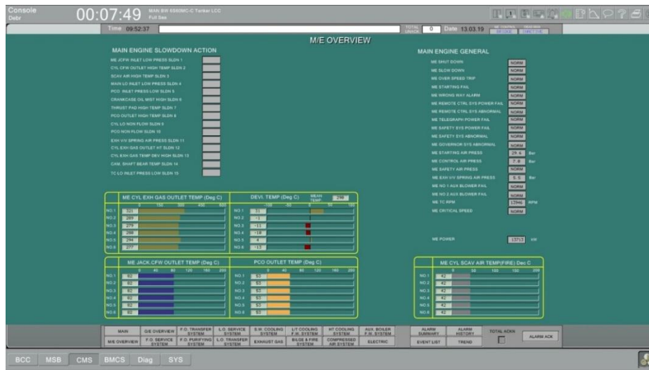
Рисунок 8 – Параметры ГД с износом поршневых колец 40%
