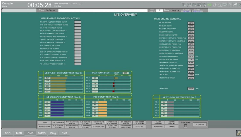
Рисунок 7 – Параметры ГД с износом поршневых колец 20 %
