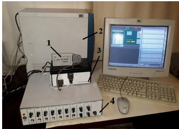
Рисунок 6 – Общий вид измерительного комплекса безмоторного стенда: 1 – модуль сбора данных m-DAQ10; 2 – системный блок персонального компьютера; 3 – модуль управления перемещением рейки (актуатором); 4 – «тензостанция» система (ТС)
