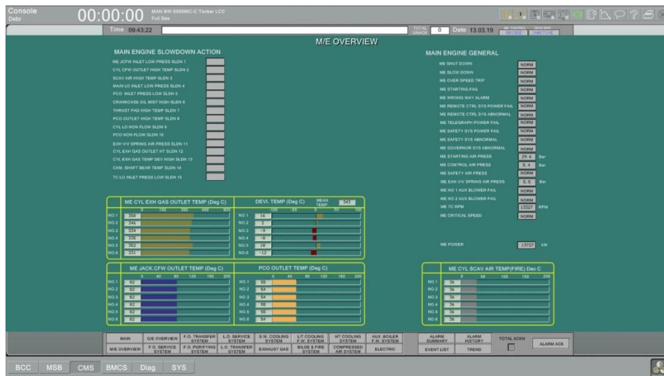
Рисунок 5 – Параметры ГД без износа поршневых колец в цилиндре № 1
