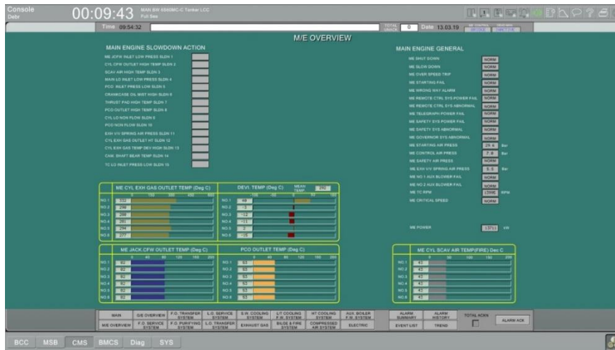
Рисунок 9 – Параметры ГД с износом поршневых колец 60%
