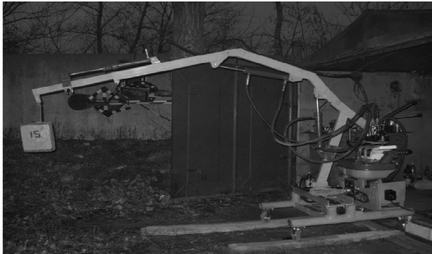
Рисунок 1 – Експериментальна установка крана-маніпулятора з гідроприводом
