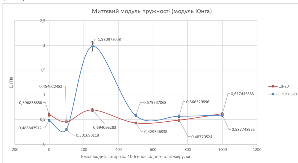
Рисунок 4 – Залежність миттєвого модуля пружності епоксидної матриці (ЕД-20 та ЕРОХУ 520) від вмісту модифікатора ТМХС-1
