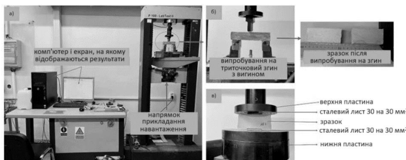
Рисунок 7 – Установка для стрес-тестування: а) випробувальна машина Instron моделі 4202, б) установка для випробувань на вигин, в) установка для випробування на стиск
