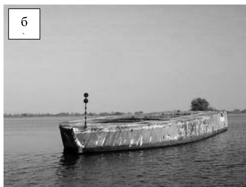
Рисунок 2 – Плавучі споруди з бетону: а) бетонне річкове судно б) баржа на Рейні
