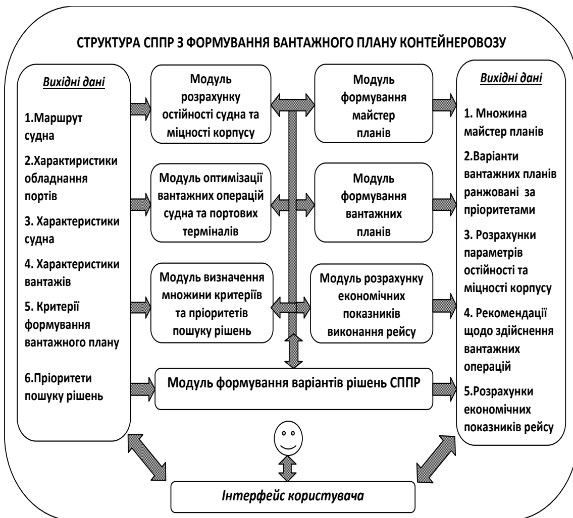
Рисунок 5 – Структура СППР з формування вантажного плану контейнеровозу для мультипортових контейнерних перевезень
