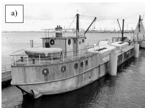
Рисунок 2 – Плавучі споруди з бетону: а) бетонне річкове судно б) баржа на Рейні
