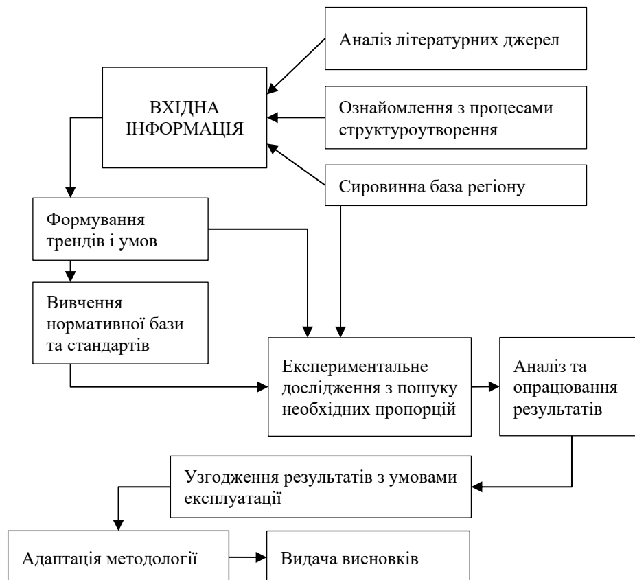
Рисунок 5 – Алгоритм наявних технологій вибору оптимальної рецептури бетонних сумішей
