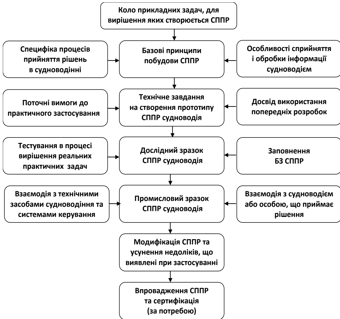
Рисунок 2 – Життєвий цикл СППР у судноводінні
