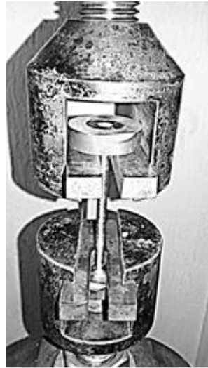
Рисунок 10 – Зразок зі знімними заплечиками, що багаторазово використовуються
