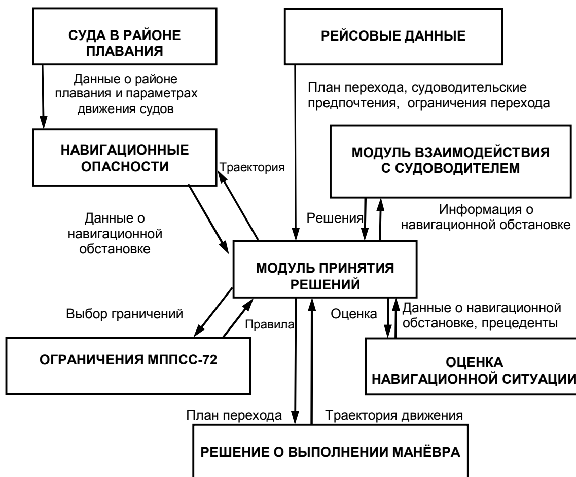
Рисунок 1 – Структура СППР судоводителя и обмен данными между ее модулями
