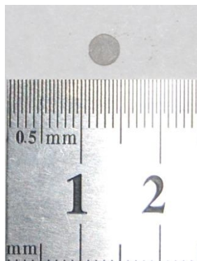
Рисунок 1 – Сформований зразок для дослідження ІЧ-спектру КвIII з товщиною b = 0,000094 мкм
