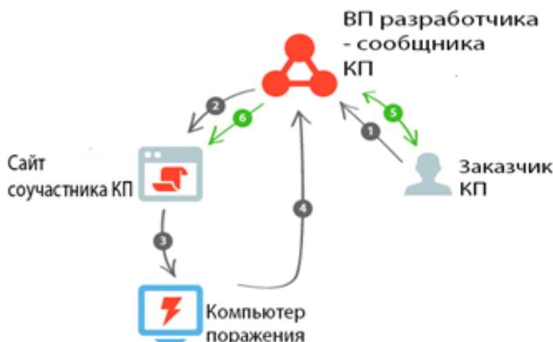
Рисунок 1 – Реализационная схема ВП с троянским вирусом проникновения
