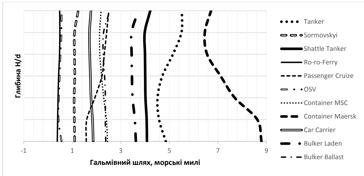
Рисунок 1 – Залежність гальмівного шляху різних типів суден від глибини моря
