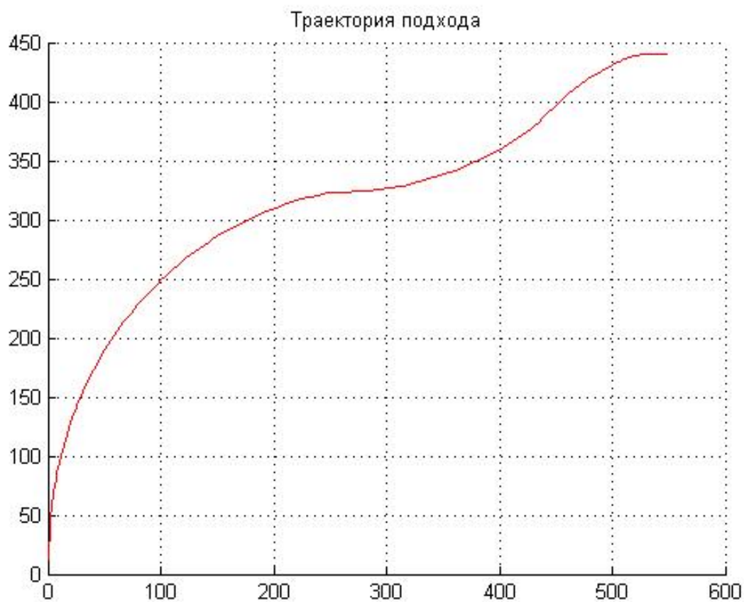
Рисунок 3 – Оптимальная по времени траектория подхода судна к объекту швартовки
