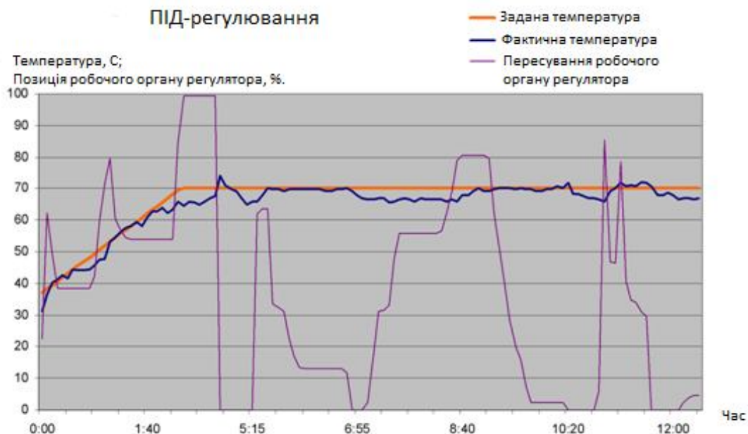
Рисунок 1 – Робоча характеристика терморегулятора системи обігріву головного двигуна при застосуванні ПІД-закону регулювання
