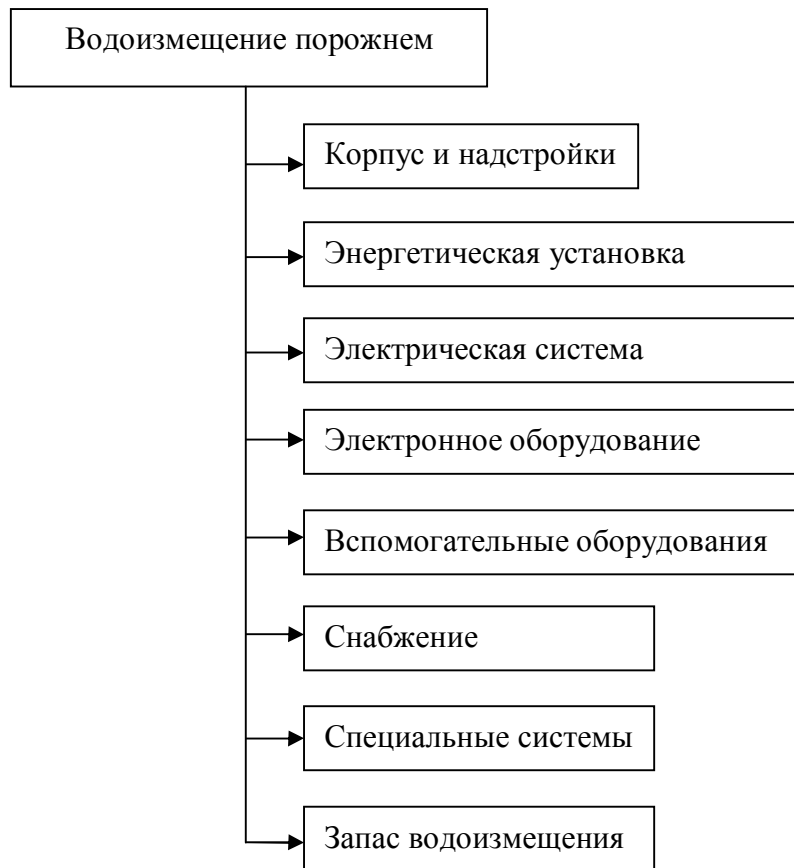
Рисунок 1 – Составляющие нагрузки водоизмещения порожнем ОБПС
