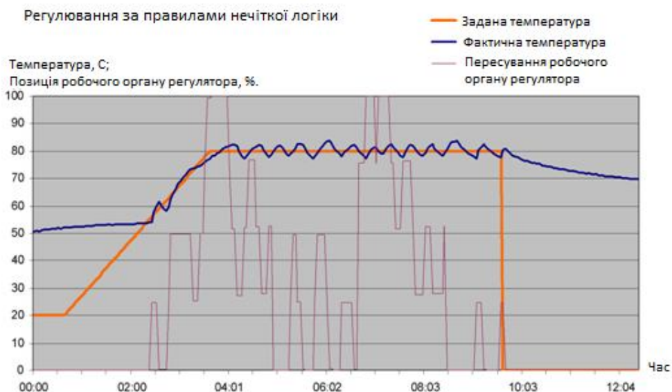
Рисунок 2 – Робоча характеристика терморегулятора парового клапану підігріву сепаратора при застосуванні правил нечіткої логіки
