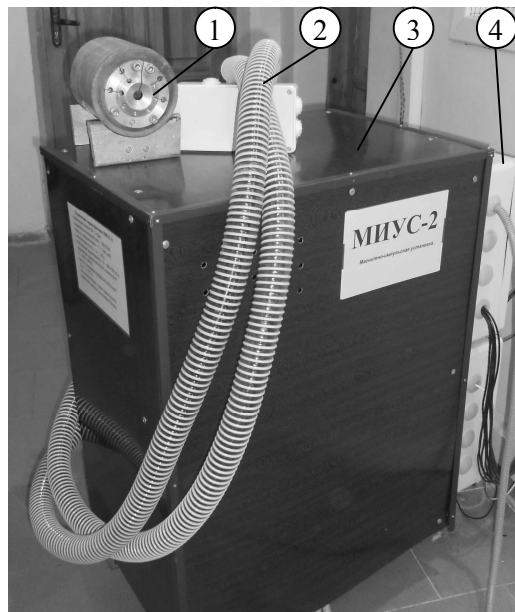
Рисунок 8 – Экспериментальное оборудование для исследования магнитно-импульсного притяжения листовых ферромагнетиков:
