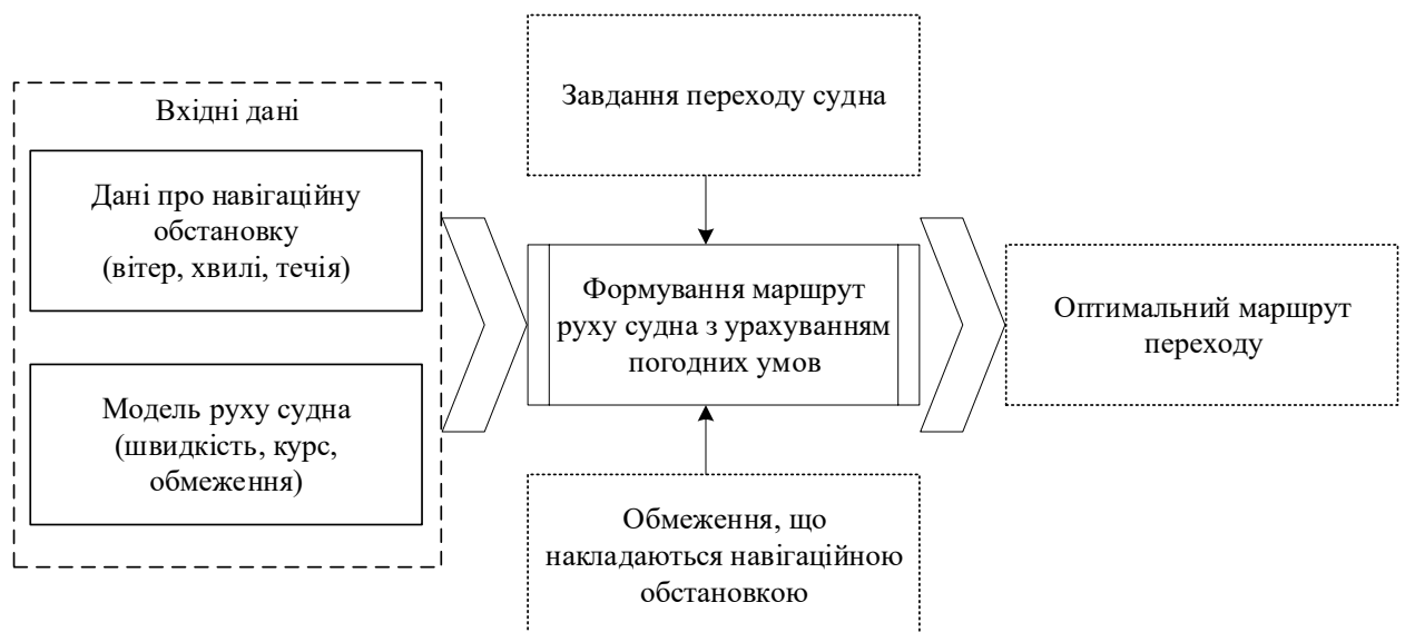
Рисунок 3.2 – Узагальнений процес оптимізації маршруту переходу судна
