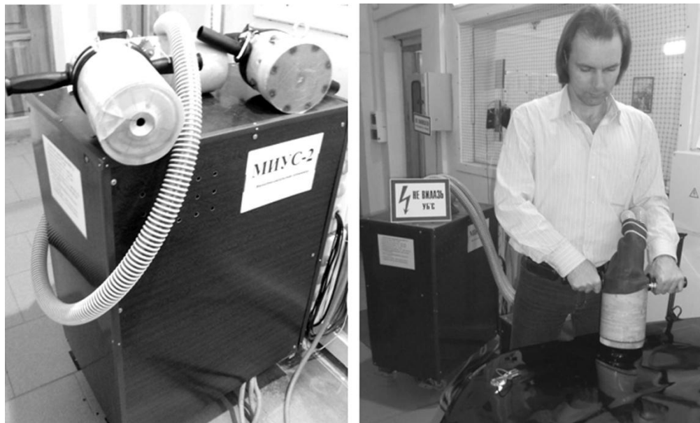
Рис. 2 – Экспериментальный комплекс внешней бесконтактной магнитно-импульсной рихтовки
