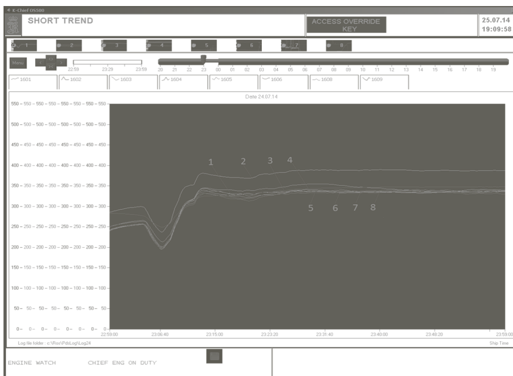
Рис. 1 – График кривых изменения значений температуры выпускных газов ДВС при изменении условий внешней среды
