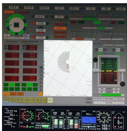
Рисунок 8 – Положення ПП попереду носа судна під час обертання ліворуч
