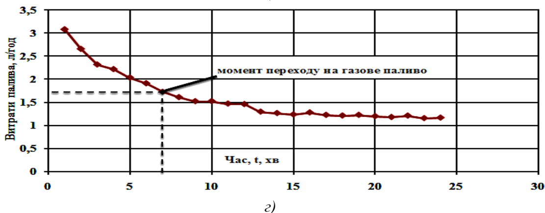
Рисунок 2 – Результати зміни параметрів технічного стану ТЗ в процесі прогріву зупиненого ТЗ в режимі х.х:
