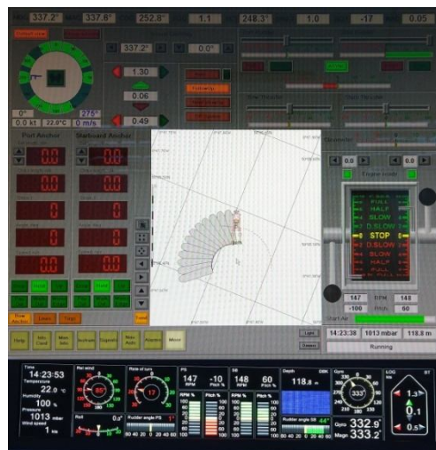
Рисунок 11 – Положення ПП позаду корми судна під час обертання ліворуч
