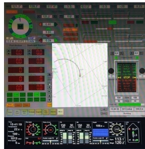
Рисунок 21 – Модель OSV 3 АН. Положення ПП в задній частині судна на ходові вперед під час обертання судна ліворуч
