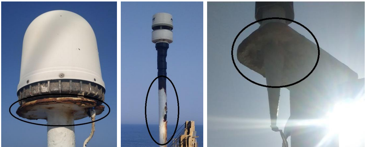
Рисунок 5 – Види пошкоджень поверхонь кронштейнів, кріплень суднових антен
