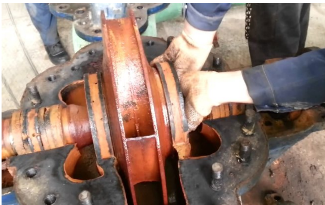
Рисунок 1.4 – Операції з розбирання відцентрового насосу
