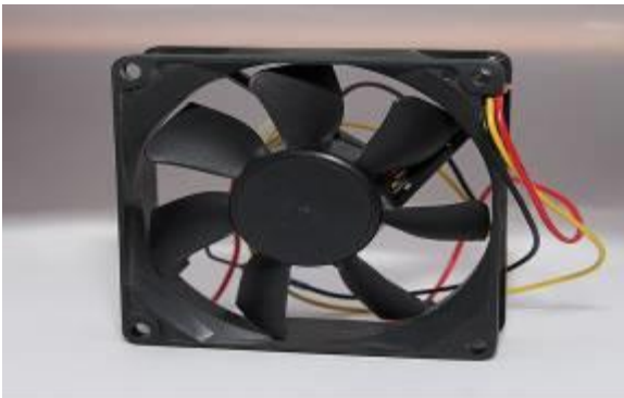
Мал. 17. Осьовий вентилятор для охолодження комп'ютера
