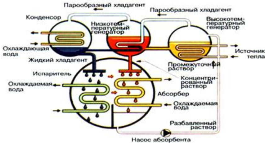
Мал. 39. Схема двоступеневої абсорбційної холодильної машини.
