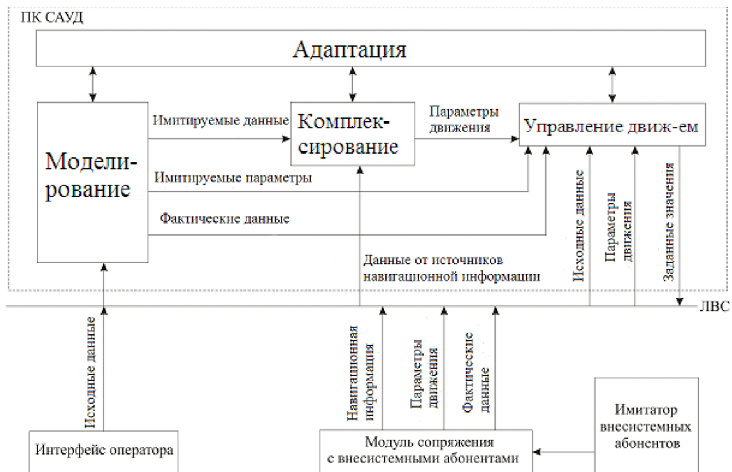
Рисунок 3.19 – Структурная схема программы моделирования
