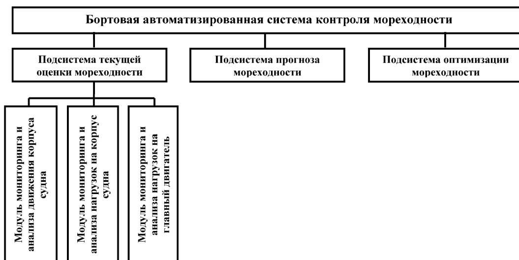
Рисунок 3.3 – Структура бортовой автоматизированной системы контроля мореходности
