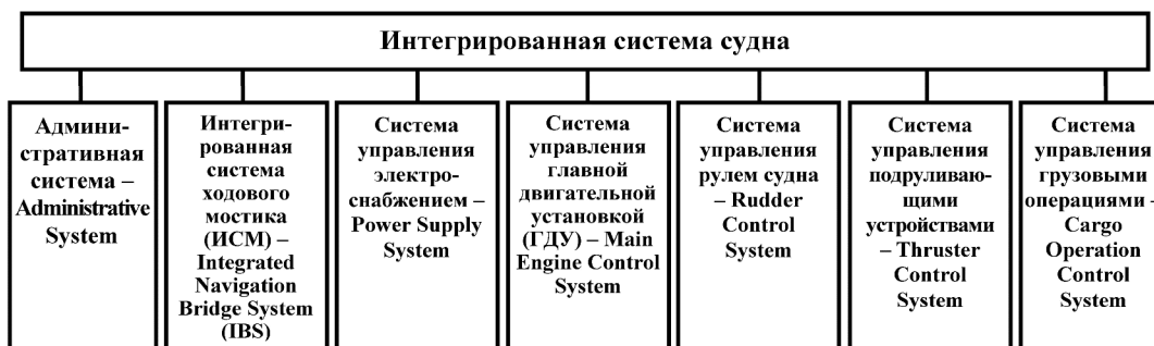
Рисунок 3.2 – Структура интегрированной системы судна
