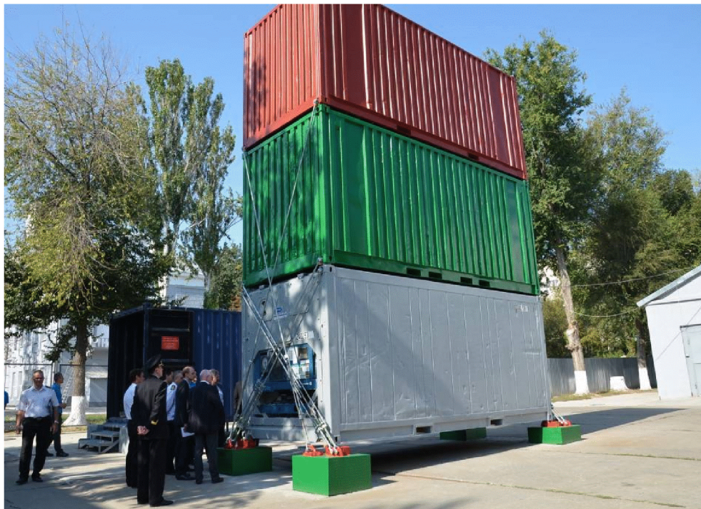
Рисунок 6.8 – Тренажерный комплекс для тренировок по креплению контейнеров на базе Херсонской государственной морской академии
