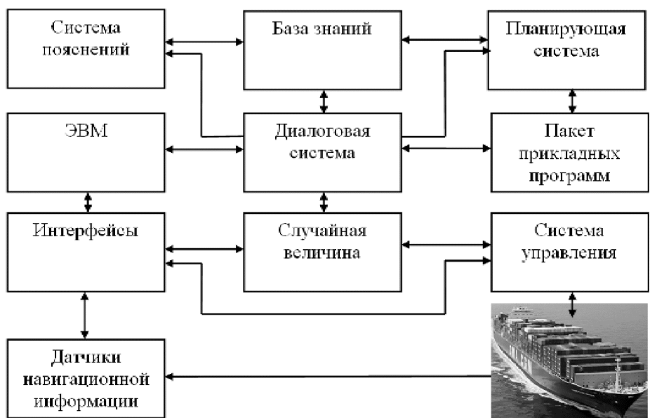
Рисунок 2.5 – Структура системы управления судном на основе ЭВМ
