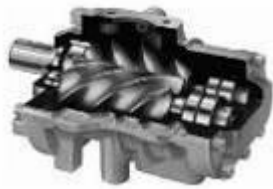
Рис. 20 Устройство двухвинтового компрессора Ротационные компрессоры
