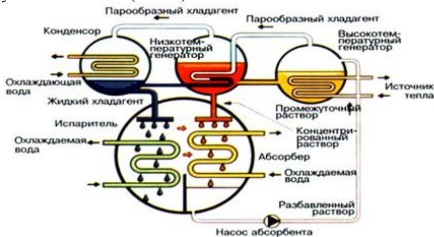
Рис. 39. Схема двухступенчатой абсорбционной холодильной машины.
