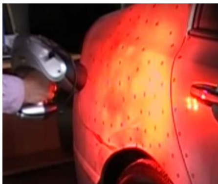
Рис. 1. Сканування крила автомобіля за допомогою лазерного 3D сканера.
