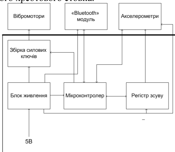
Рис.6 Структурна схема системи просторової ідентифікації положення сегментів лікувального корсету
