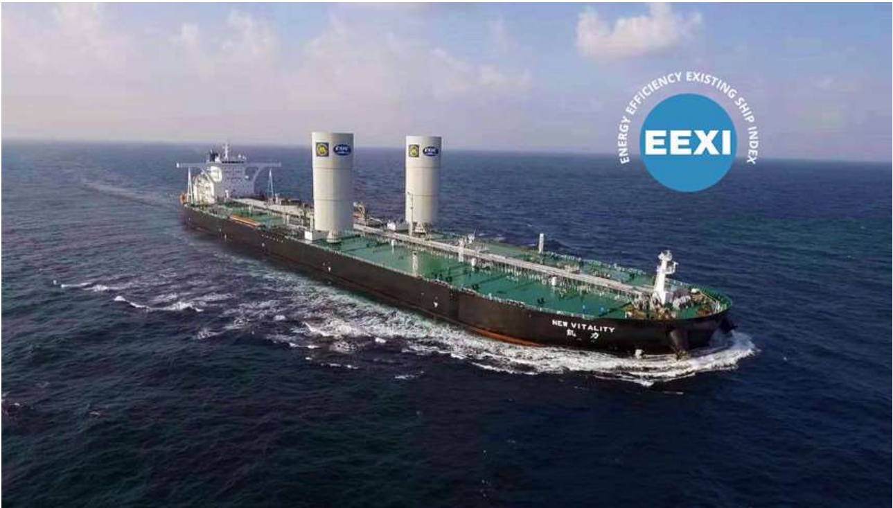
Рисунок 1 – Приклад проекту судна, яке задовольняє вимогам EEXI
