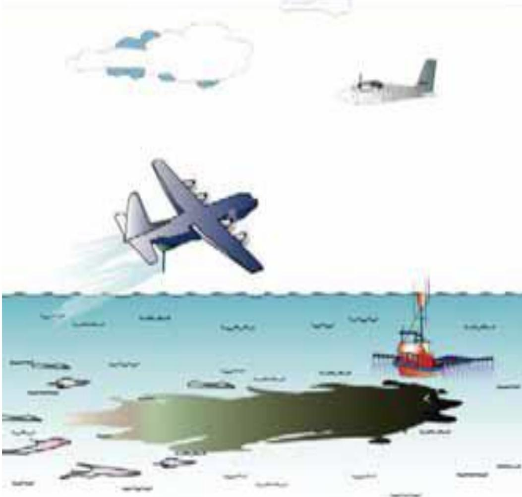
Рисунок 8.6– Типовая надводная диспергирующая система ликвидации нефтяных разливов (в виде плёнки)
