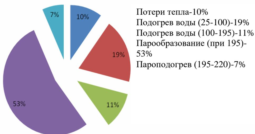
Рисунок 7.6 – Степень использования теплоты ОГ СЭУ.
