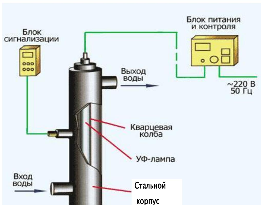
Рисунок 8.10 – Установка УФО-обработки балластной воды
