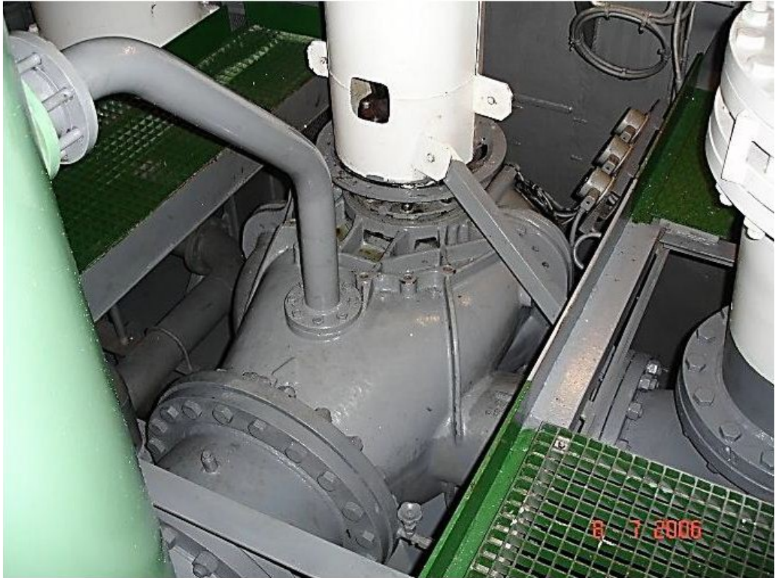
Рисунок 2.2 Розміщення вантажного насосу Kosaka CVS-150
